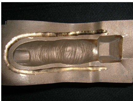
Slika 19: Del orodja za protezo prsta izdelan z DMLS tehnologijo
