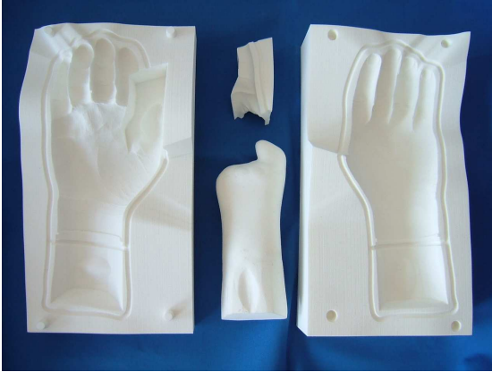
Slika 21: Orodje za protezo po delni amputaciji dlani izdelano s SLS tehnologijo
