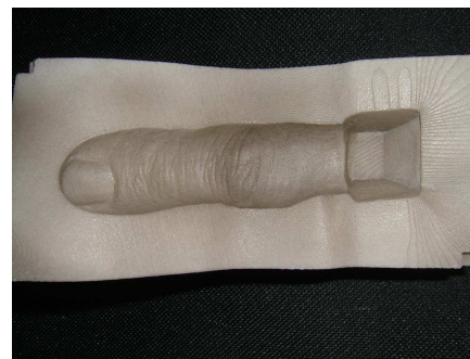
Slika 20: Del orodja izdelan s tehnologijo SLS
